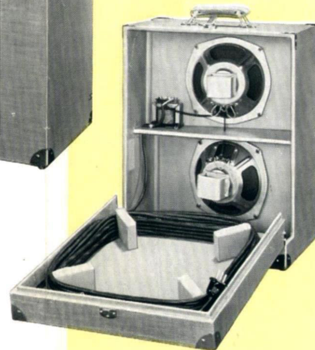
2 x 6-Watt-Kofferlautsprecher als Breitstrahler, Innenansicht
