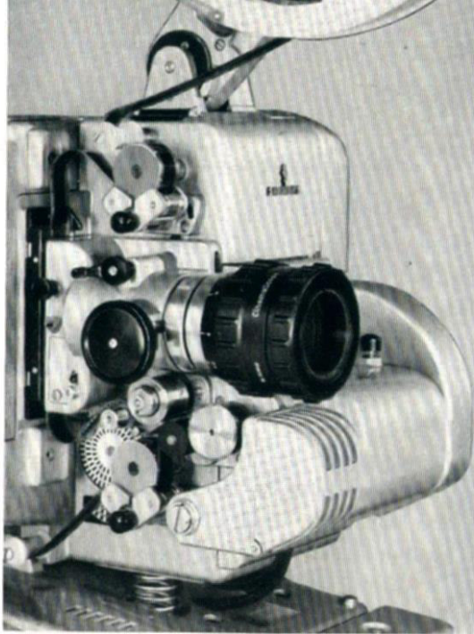
Anamorphot zur Vorführung von CinemaScope- und Breitwandfilmen
